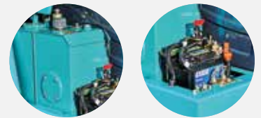
01 KRAFTSTOFF-/HYDRAULIK-TANK UND BATTERIE
